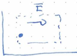
Neutral: al no tener carga eléctrica no es afectado por el campo eléctrico así su movimiento será M.R.U e  $V = \text{cte}$
